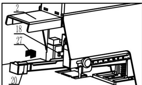
1. Поднимите переднюю откидную крышку (2), это предотвратит степлирование.
