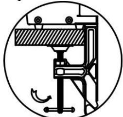
2. Ослабте пробойник и шплинт, установите рабочую поверхность на наковальне, затем зафиксируйте рабочую поверхность и согласующее устройство при помощи пробойника. Застопорите все при помощи шплинта.
